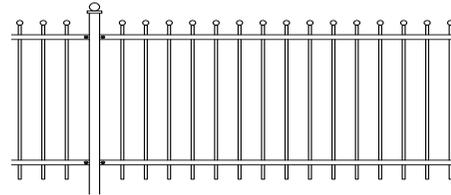
Füllstäbe: Kastenprofil 14 x 14 mm
