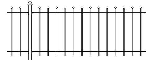
Füllstäbe: Kastenprofil 12 x 12 mm
