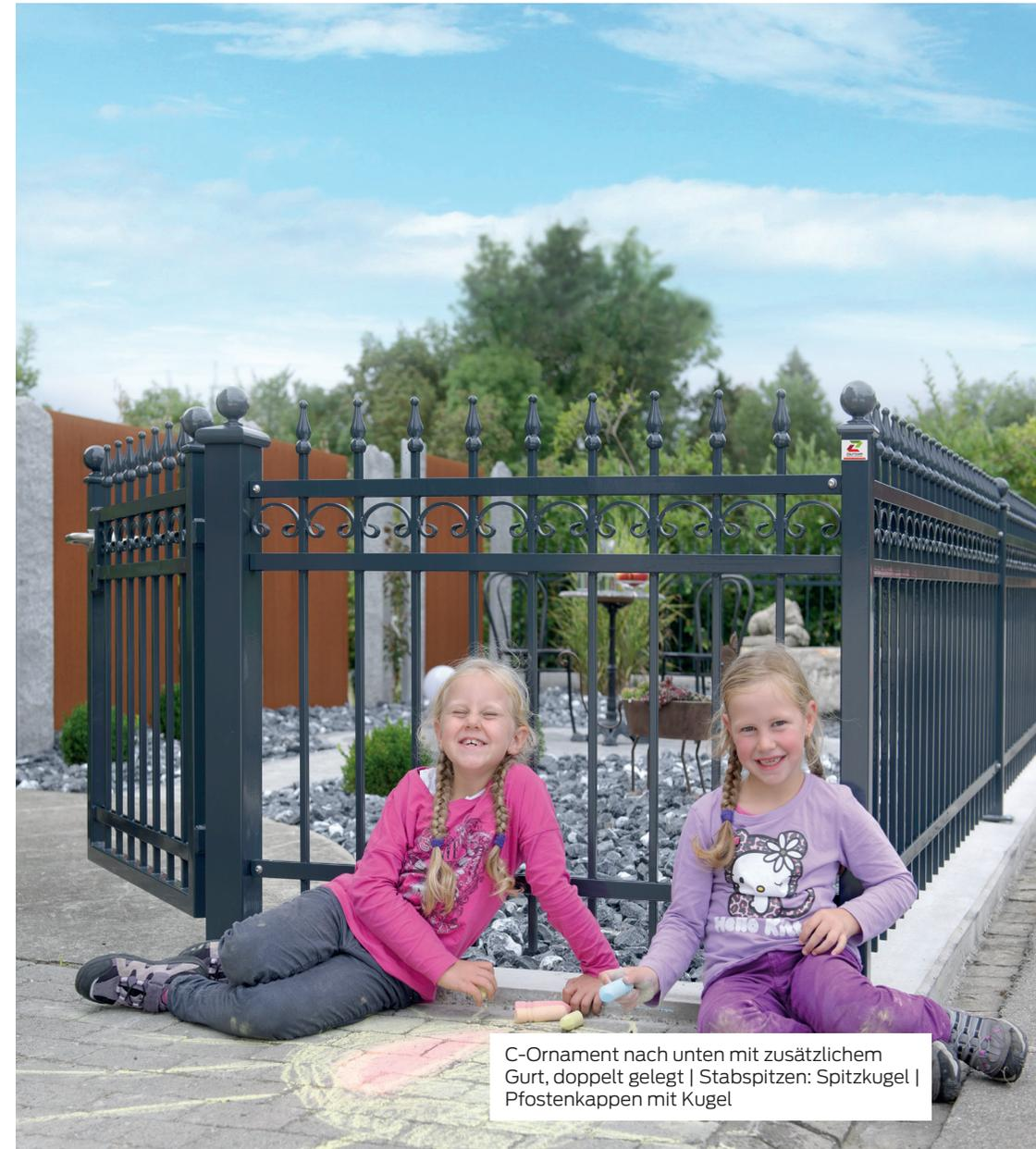
C-Ornament nach unten mit zusätzlichem Gurt, doppelt gelegt | Stabspitzen: Spitzkugel | Pfostenkappen mit Kugel
