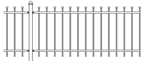
Füllstäbe: Kastenprofil 12 x 12 mm
