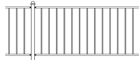
Rahmen: Kastenprofil 30 x 30 x 2 mm
