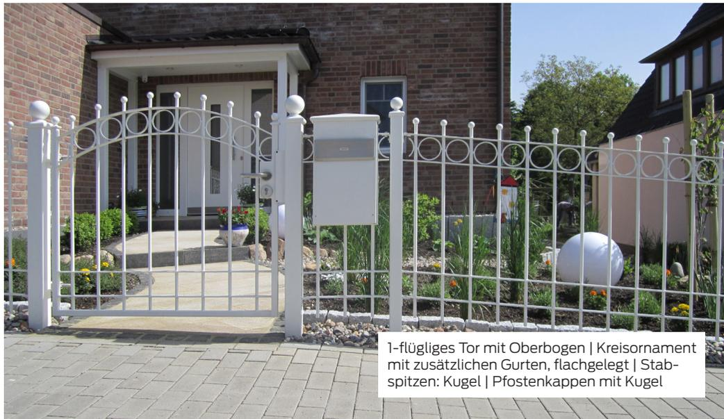
1-flügliges Tor mit Oberbogen | Kreisornament mit zusätzlichen Gurten, flachgelegt | Stabspitzen: Kugel | Pfostenkappen mit Kugel
