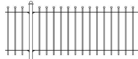
Füllstäbe: Kastenprofil 14 x 14 mm
