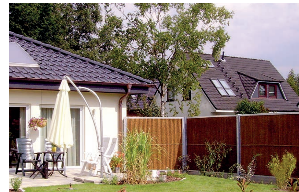
Sicht- und Lärmschutz aus Kokosfasern, geeignet als leichte, wirtschaftliche Lärmschutzvariante
